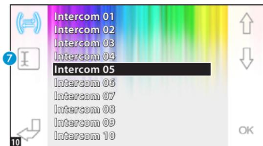
Выберите абонентское устройство, имя которого нужно изменить, с помощью кнопок и нажмите кнопку **7**.
