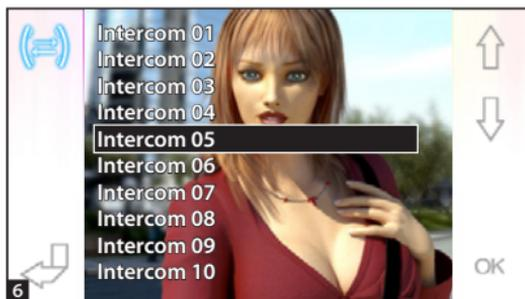
Выберите желаемое абонентское устройство с помощью кнопок **↑** **↓**; нажмите ОК, дождитесь ответа от вызываемого абонентского устройства; для переадресации вызова завершите связь нажатием кнопки **📞**.
